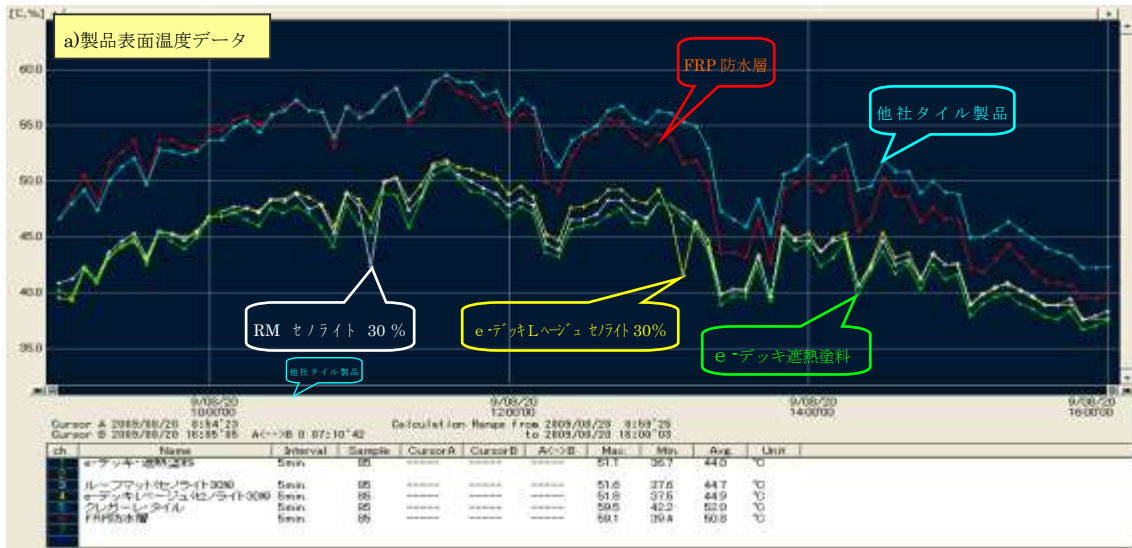
赤外線放射温度計使用 測定時刻 13時
